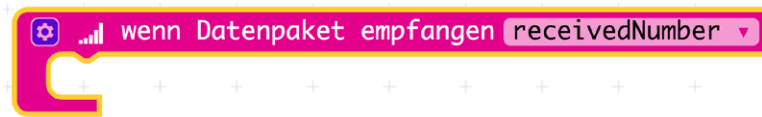
Abb. 9-2 Dieser Befehlsblock registriert Funktionen, die ausgeführt werden, wenn ein Datenpaket über Funk empfangen wird.
