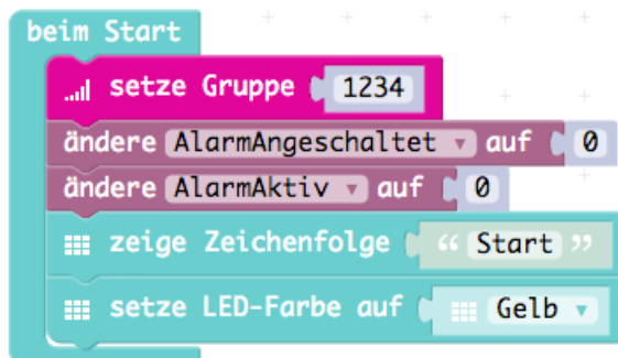
Abb. 9–13 Gruppe, erste Platzhalter für die Alarmanlage
