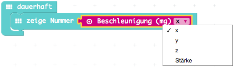
Abb. 4–3 Der Programmierblock für den Beschleunigungssensor und seine Auswahlmöglichkeiten
