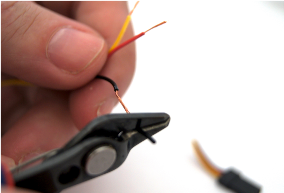
Abb. 10–17 Die Kabelenden werden entmantelt.
