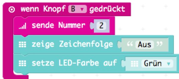
Abb. 9–18 Fernbedienung: ... und Knopf »B« zum Abschalten
