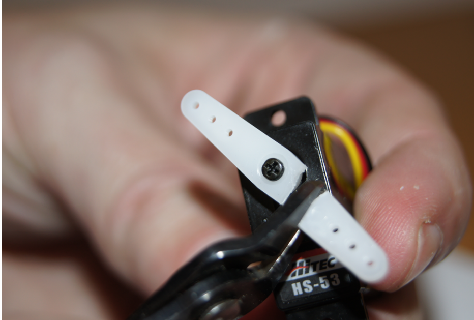
Abb. 10–15 Ein Servo-Arm wird entfernt
