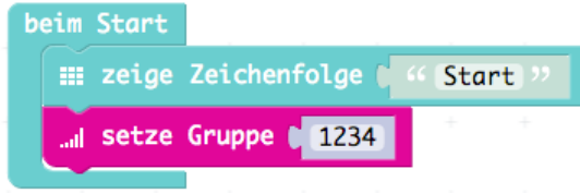
Abb. 9–16 Fernbedienung: Wähle die gleiche Gruppe wie die Alarmanlage.
