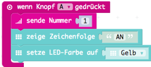
Abb. 9–17 Fernbedienung: Knopf »A« zum Anschalten ...
