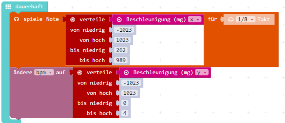
Abb. 8–36 Mapping mit der y-Achse des Beschleunigungssensors
