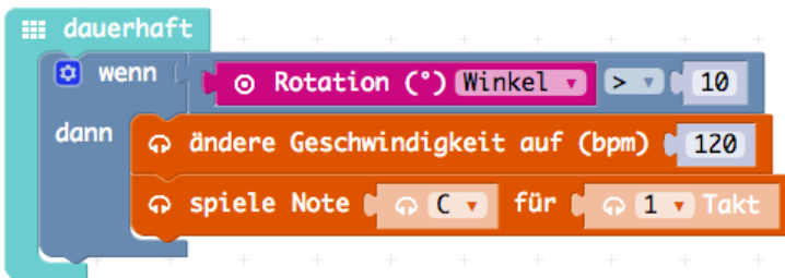
Abb. 9–12 Alarmanlage mit Winkelmessung
