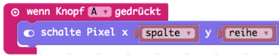
Abb. 5-22 Schalte diejenige LED ab, die in dieser Spalte und dieser Reihe ist.
