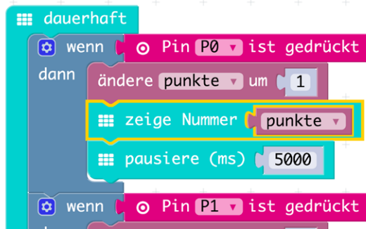
Abb. 7–25 Erweiterung des Programmiercodes um die Anzeige der Punkte und einer Pause zum Herausholen der Spielkugel aus dem jeweiligen Spielloch
